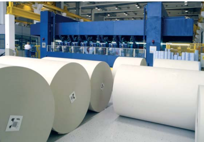
VariTop™ mit 8.300 mm Arbeitsbreite für SC-A-Papiere
