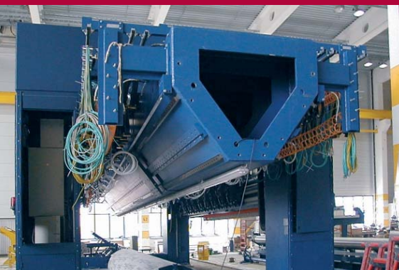
VariTop™-Zentraltraverse zur Aufnahme der Wickelstationen – Werkmontage
