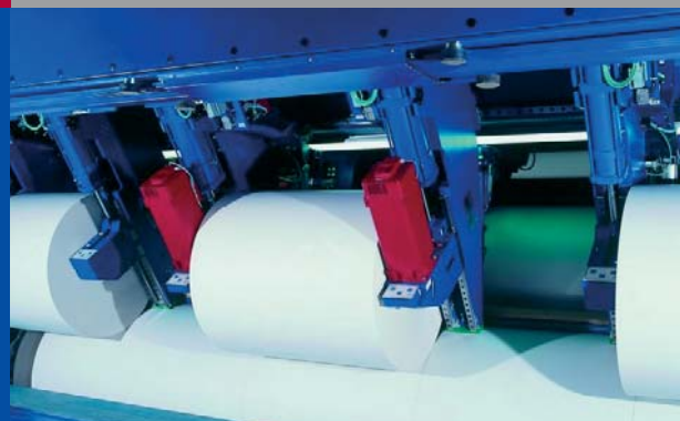
Die „aufgehängten“ Aufwickelstationen beim VariTop™
