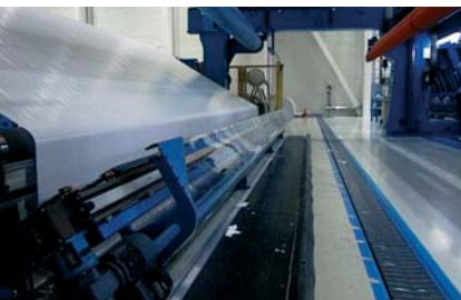
Der Butt-Splicer verbindet automatisch alte und neue Papierbahn.
