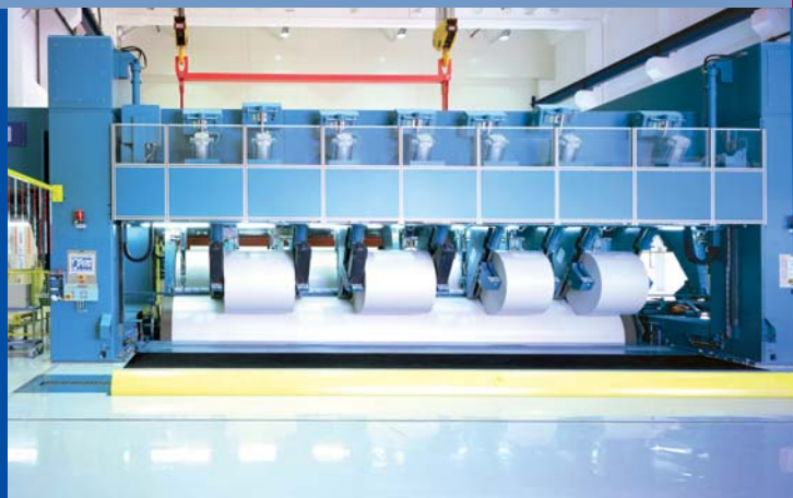
VariTop™ mit 9.000 mm Arbeitsbreite für SC und LWC-Offset und Tiefdruck
