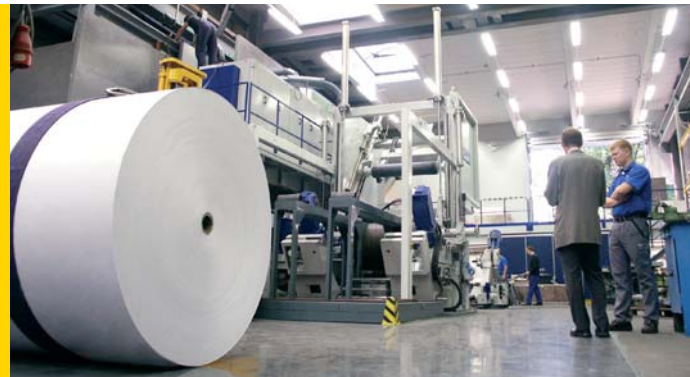
Auf dem Versuchsrollenschneider im Krefelder Technologiezentrum werden ständig Versuche im Beisein von Kunden aus aller Welt gefahren.
