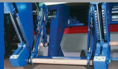
Aufnehmen der Hülsen durch die Führungsköpfe der Wickelstationen
