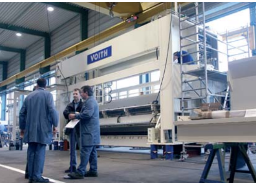
Schon während der Werkmontage werden wesentliche Funktionen der Voith Paper Rollenschneider gemeinsam mit den Kunden getestet.
