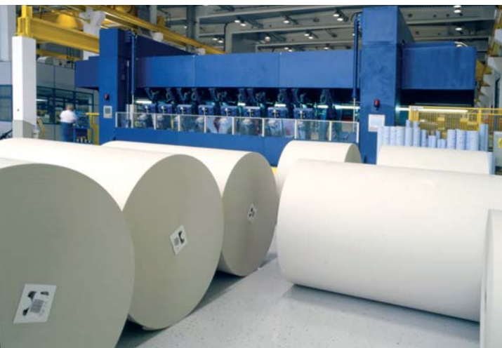
VariTop™ mit 8.300 mm Arbeitsbreite für SC-A-Papiere
