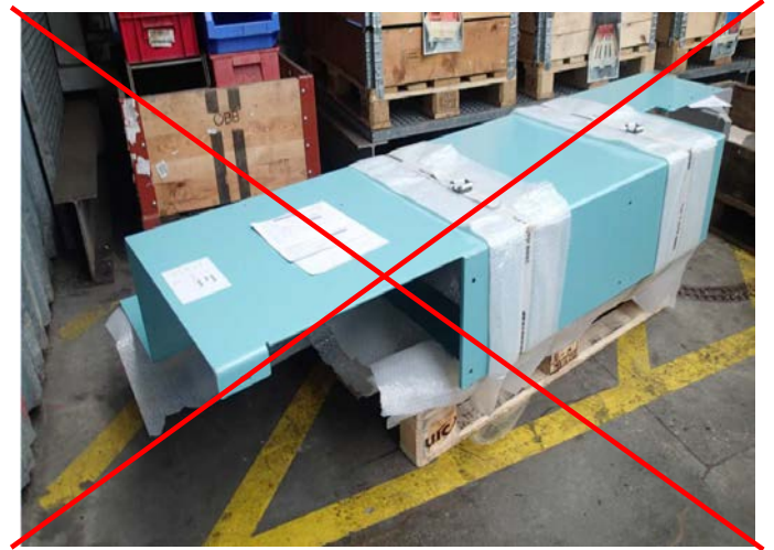
图2：不正确的托盘包装
