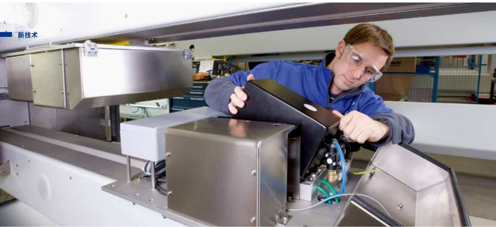
图 1: 福伊特技术人员在工厂安装并测试福伊特 LSC TecoScan 系统。
