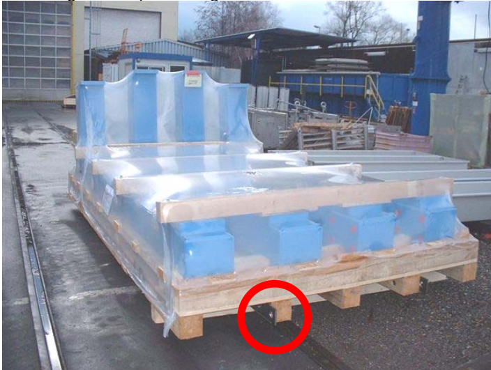
Abbildung 15: Beispiel für Zuglaschen am Containerboden
