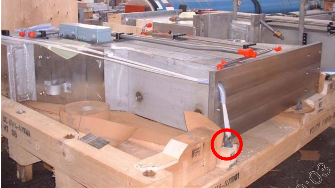
Abbildung 13: Ringösen am Containerboden
