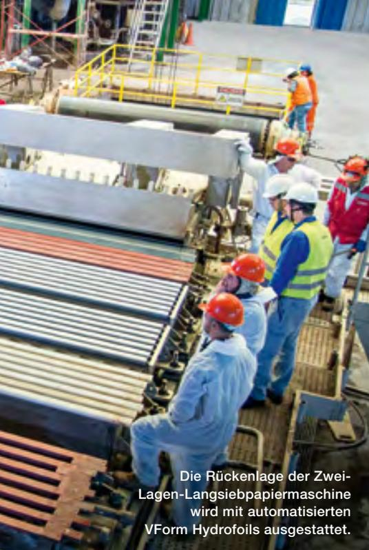
Die Rückenlage der Zweilagen-Langsiebpapiermaschine wird mit automatisierten VForm Hydrofoils ausgestattet.
