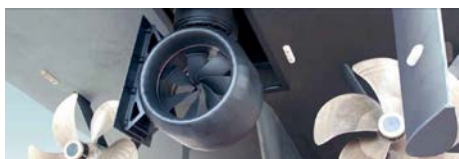
VIP1000-300 als ausschwenkbarer Hilfsantrieb.
