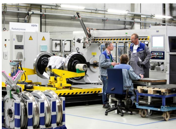
Bild 1: Die Radsatzpresse im Voith Rail Service Center ist Teil der Drehgestellwerkstatt in der viele verschiedene Prozesse unter einem Dach ineinandergreifen.
