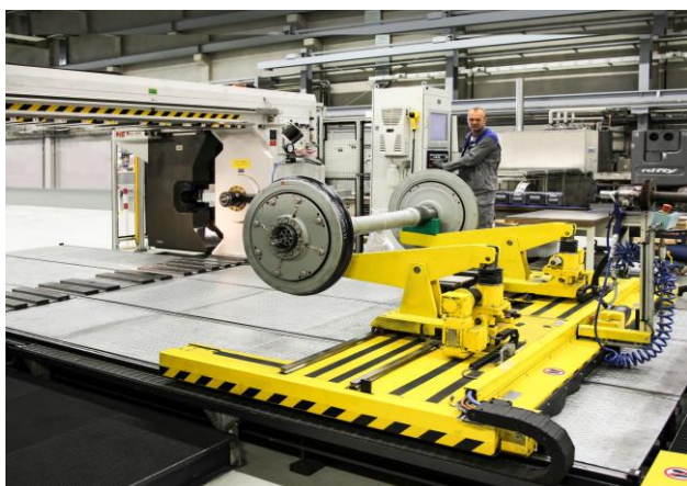
Bild 3: Mit der neuen Drehgestellwerkstatt inklusive Radsatzpresse und Prüfständen ist Voith in der Lage, Drehgestellüberholungen deutlich schneller zu realisieren.
