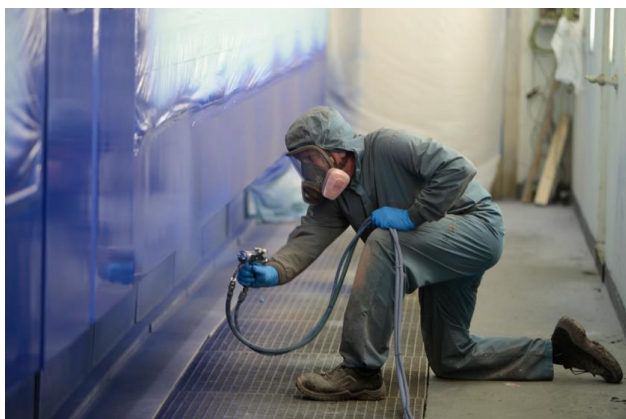
Bild 2: In der Lackierstraße werden in die Jahre gekommene Züge und Triebwagen nach dem Abschleiff und der Aufarbeitung wieder neu lackiert.
