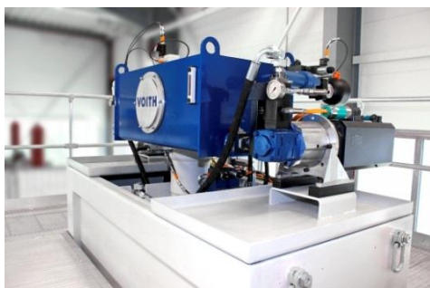
Bild 1: Der Pressenantrieb Servo Hybrid von Voith erlaubt eine optimale Anpassung von Kraft und Geschwindigkeit. Mit dem Einsatz einer servohybriden Ziehkissensteuerung sparen Betreiber bis zu 80 % Energie.
