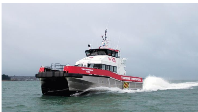
Das Crew Transport Vessel wird von zwei Voith Linear Jets (VLJ) angetrieben
