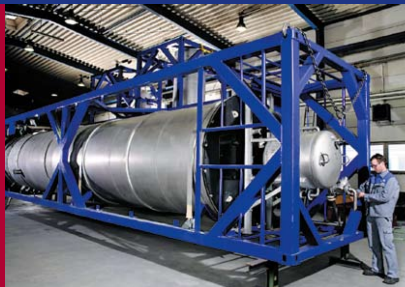
Tuotantomittakaavainen R2S anaerobinen EGSB-koereaktori valmiina ensimmäiseen asennukseen
