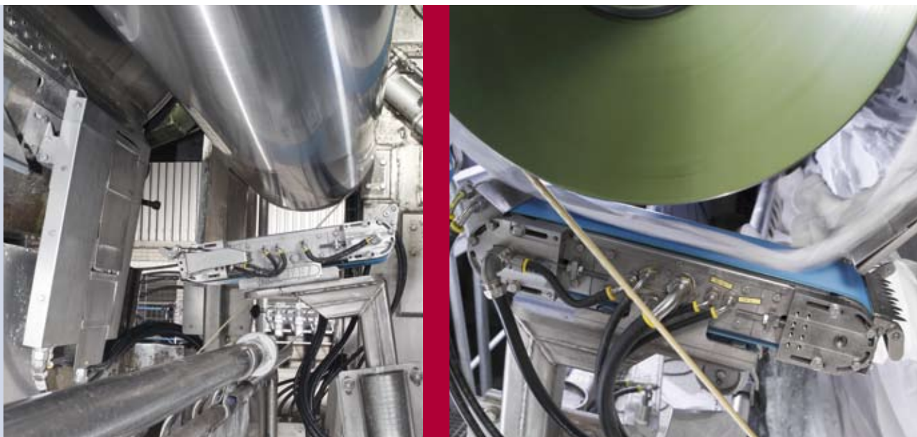
Kuva 4: Prevo-päänvientijärjestelmä paperikoneen SpeedSizerilla (Vasemmalla: käyttöasento; oikealla: radan pään onnistunut vienti).
