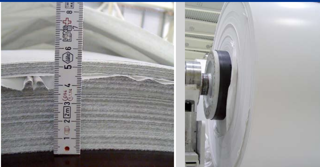
图 2: 卷取缺陷的例子
