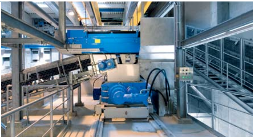
分离金属和切碎是高热值废料燃烧的先决条件
