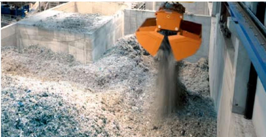
一个自动推进的智能化吊车系统把燃料从仓库中取出后喂入二次处理段（混合与喂入系统）
