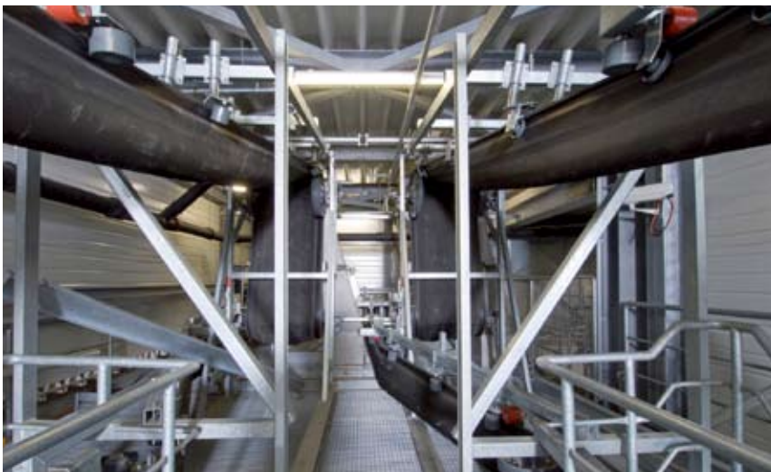
密闭袋式的皮带输送机即便在复杂的输送路线上也能游刃有余地输送燃料
