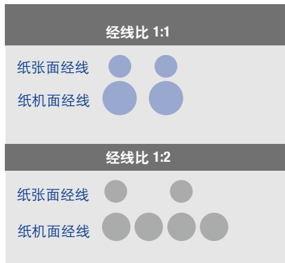
图 1: 1:1 和 1:2 经线比的 SSF 成形网的横剖面之比较
