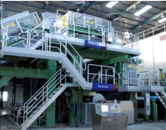
采用 JetFlow 技术的 DynaCoat AT 涂布机保证了最佳的涂料施涂
