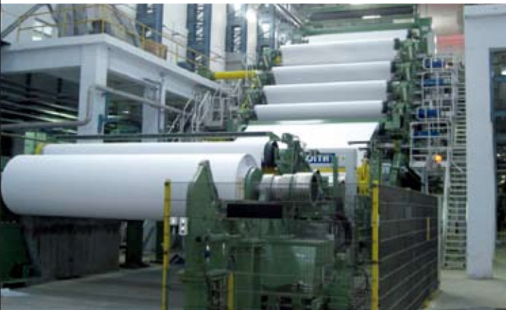
一台 Janus MK2 十辊压光机可以进行最佳的表面处理
