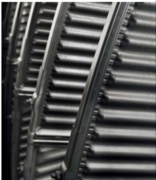
白水回收机的无滤袋式扇形片。
