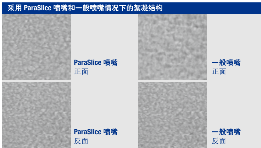
图 5: 采用 ParaSlice 喷嘴使喷射浆流正反面的絮凝差异降至最低限度。
