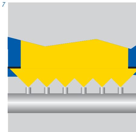
Fig. 7: Edge deckle adjustment.
