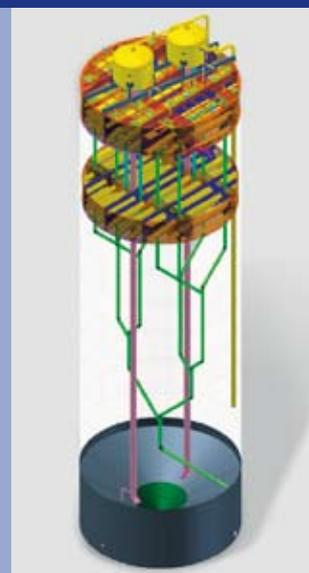
Der neue anaerobe R2S-Reaktor (patentiert)
