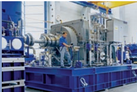
迄今最大的 Vorecon (33兆瓦) 在 Crailsheim 的测试工作台上
