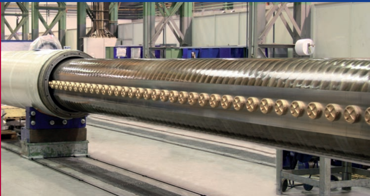
同一根 Nipcorect 辊改造成含有背撑元件的辊子
