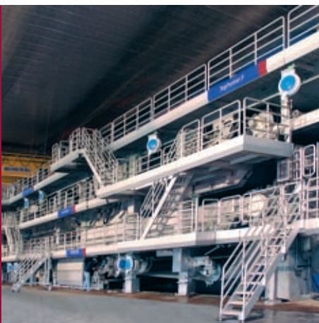
图 1: 可以在多层纸板机的各个单层的网前箱上进行测量
