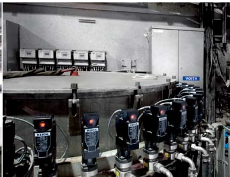
图 2：OnQ ModuleTap 执行器控制现有的稀释水流浆箱。
