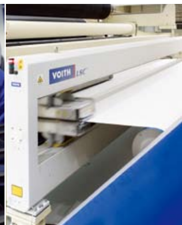
图 3: 福伊特 LSC 扫描架检查纸张质量。
