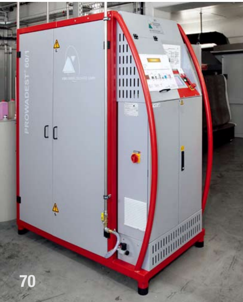
图 1：德国海德海姆的真空蒸馏系统，每年可以减少 200 吨废弃乳胶。
