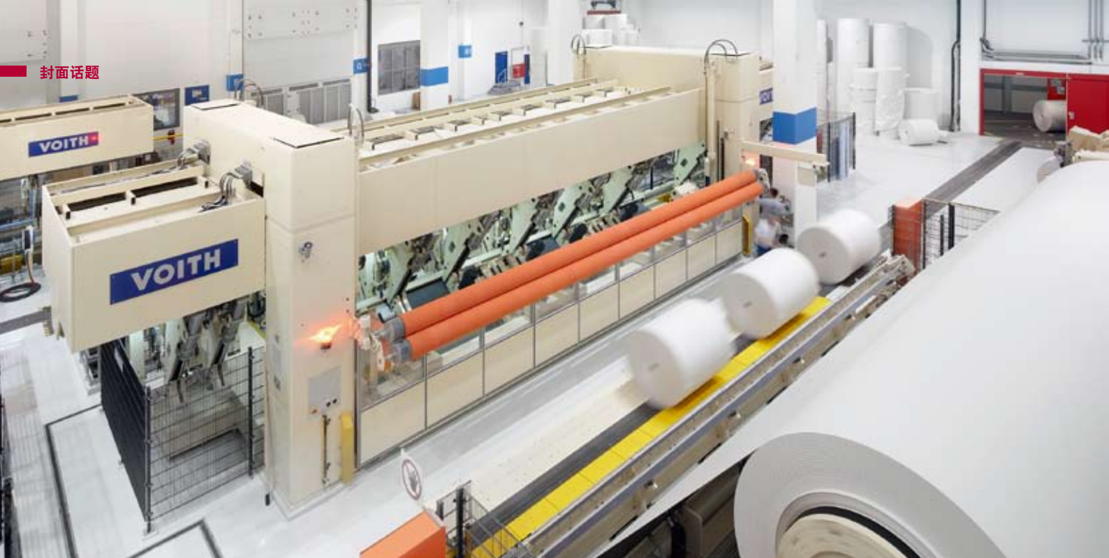
图 4：两台 VariTop 复卷机的中心卷取原则确保了良好的卷芯紧致程度，这对于快速运行的印刷机器是一个重要的质量参数。
