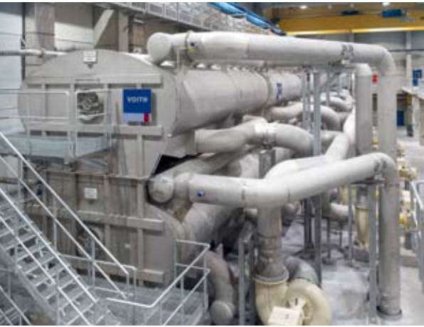
图 1: Perlen 纸业的新型 LowEnergyFlotation(LEF) 节能浮选系统。
