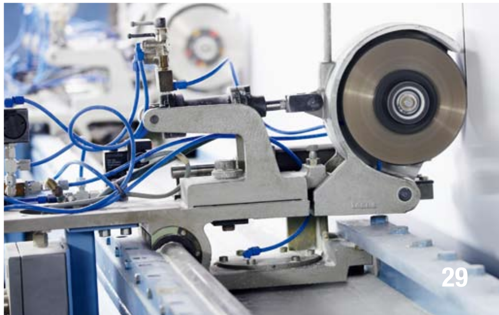
图 4: 切刀站，复卷机的核心部件之一。
