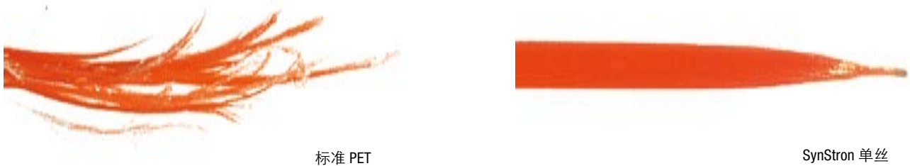
图 4: SynStron 丝线不易发生纤维化。与之形成对比的是, 标准 PET 丝线 (左图) 在突然断裂后会产生大量纤丝。
