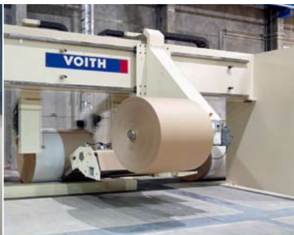
图 2：ClassicPlus 纸卷包装机的移动式卷取端头。
