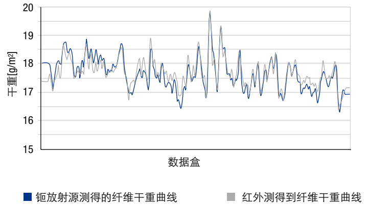
图 3: 传统放射测量与福伊特 LSC TecoSens 的平均值 (卷取部) 对比。
