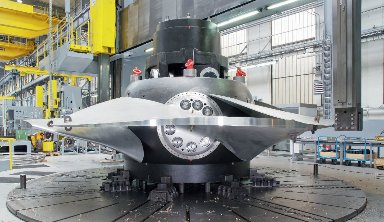
Turbina Kaplan en el taller de Voith en Heidenheim, Alemania.
