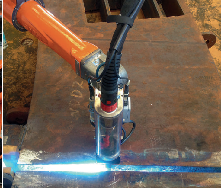
Soldadura en ranura estrecha en el taller de Voith Hydro en Shanghái.
