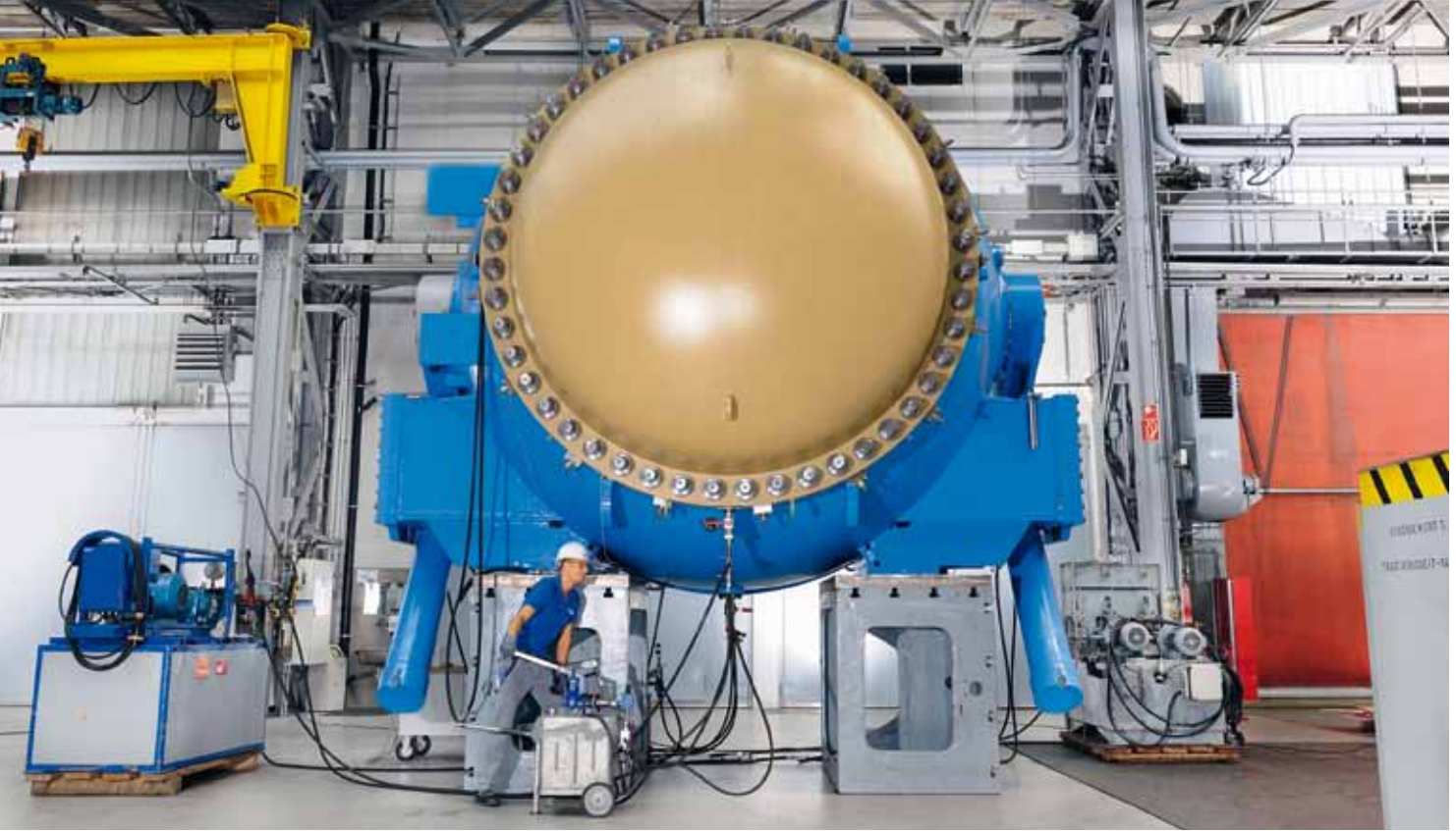
Letzte Handgriffe an einem der beiden Ventile vor der Auslieferung und Montage
