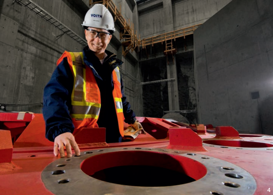
4 Inspeccionando a chegada de novos equipamentos: Marc Gagnon de pé dentro de uma das tampas das turbinas. 5 Trabalhadores dentro da caixa espiral, que é quase do mesmo tamanho que um túnel ferroviário subterrâneo.
