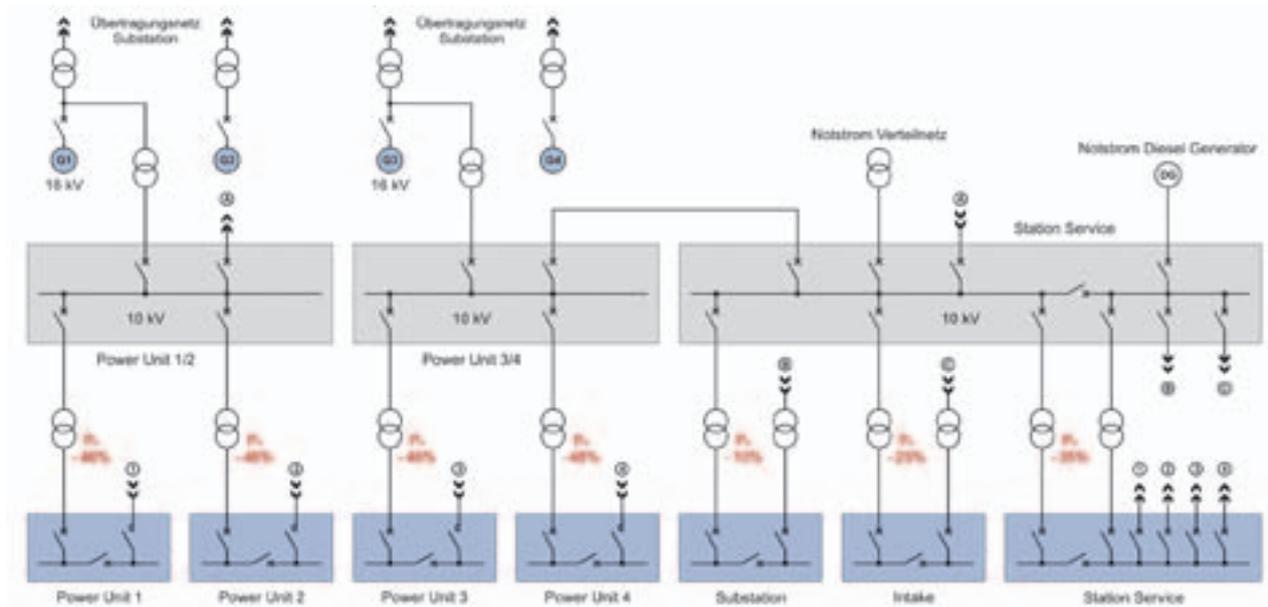
Die Umwandlung der Wechselspannung verursacht jedoch Energieverluste. Das Station Supply AC System minimiert diese Verluste und ermöglicht Wasserkraftwerken so einen äußerst ökonomischen Betrieb.
