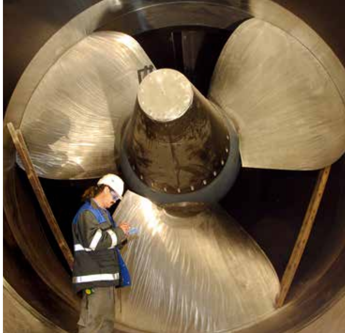
欧洲同类产品最大的水轮机：拉托姆埃斯卡普兰竖井式水轮机
