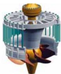
Représentation schématique d'une turbine Kaplan avec aube à écart minimal
