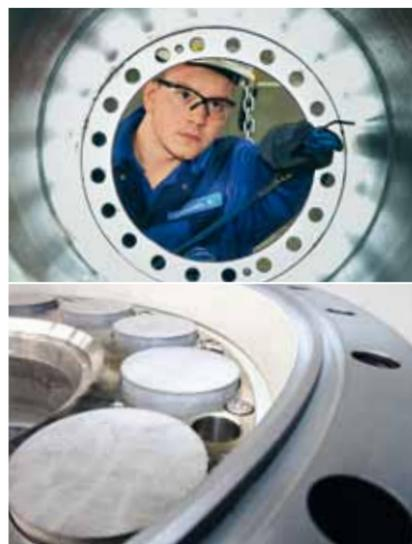
L'aspect écologique était un facteur clé dans la mise au point de la StreamDiver. Les paliers sont l'une des caractéristiques importantes, ils sont lubrifiés entièrement par de l'eau afin d'éviter la contamination par l'huile et la graisse.
