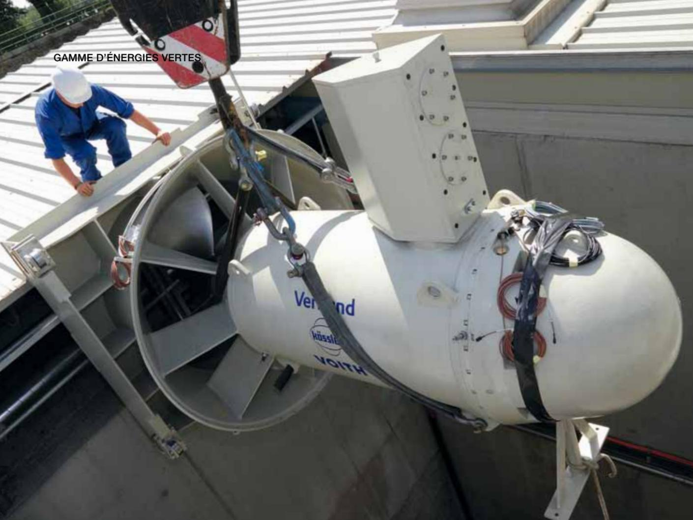
En raison de son petit format, la StreamDiver est particulièrement utile dans les endroits où des nappes intrusives et des bâtiments sont déjà en place pour réguler les petits lits de rivière. Elle nécessite peu d'entretien et une vérification technique est nécessaire seulement tous les cinq ans.
