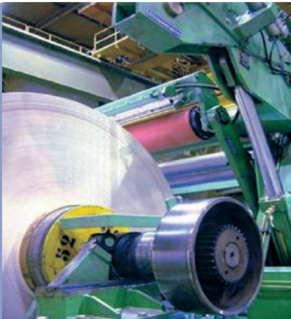
Flying Splice Installation für LWC-Anlage 7.710 mm
