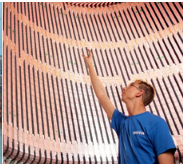
**Mit Cooling on demand hat Voith Hydro ein intelligentes Management des Kühlwassersystems für Generatoren entwickelt. Es reduziert die Wassermenge und den Energiebedarf bei der Kühlung.**
