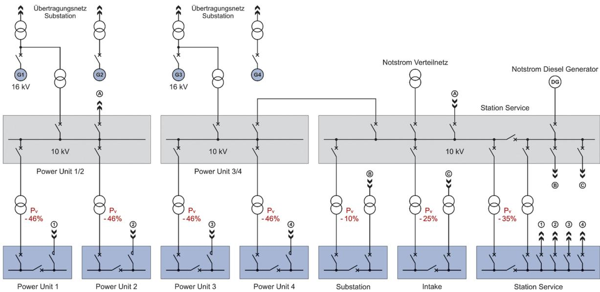
Die Umwandlung der Wechselspannung verursacht jedoch Energieverluste. Das Station Supply AC System minimiert diese Verluste und ermöglicht Wasserkraftwerken so einen äußerst ökonomischen Betrieb.
