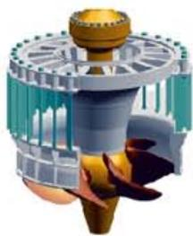
一种最小叶片间距转轮Kaplan水轮机的图示
