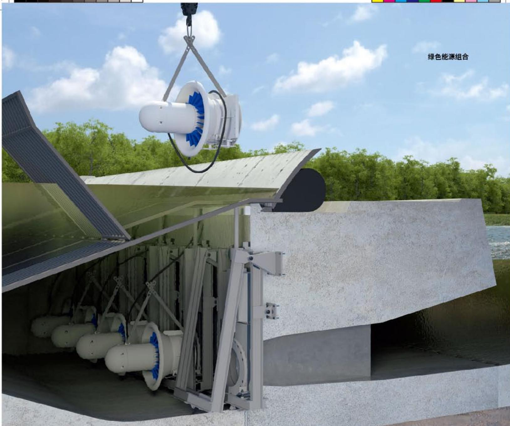
StreamDiver为传统水电厂提供了一种灵活的替代方案，它可以作为单独的水轮机安装，也可以成套安装，如图所示。
