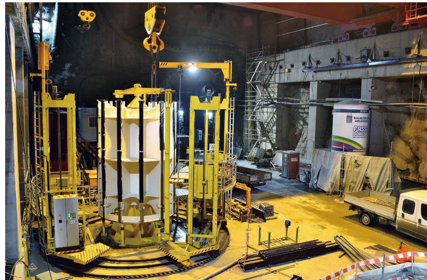
組立室にて積層作業の開始を待つ回転子ハブと新たに開発された半自動式鉄心積みプラットフォーム
