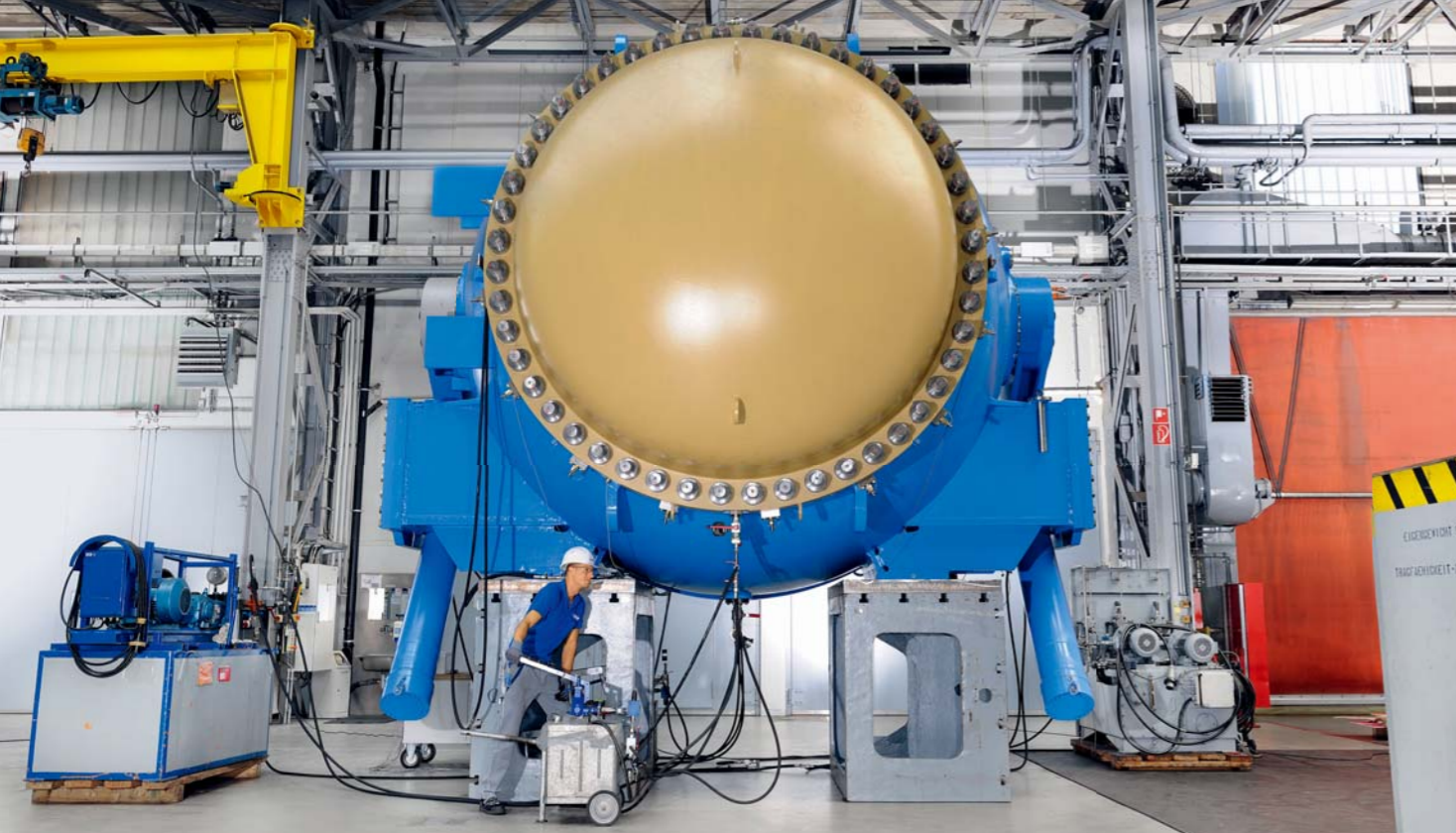
輸送と据付に先立ち、2台の入口弁のうち1台に仕上げの作業を施します。
