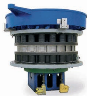
Distribuidor reacondicionado para una turbina Francis vertical de 38 MW.
