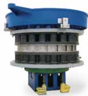
Un distributeur de turbine Francis Verticale de 38 MW remis à neuf.
