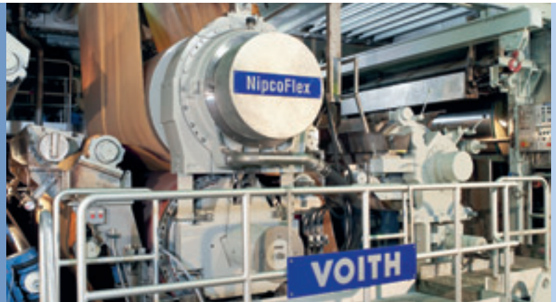
Kuva 3: Kartonkikone uusinnan jälkeen. Etualalla imusylinterit täyteainelisäykseen sekä FloatLip-formerit.
