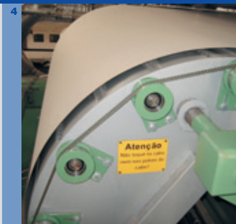
Abb. 3: Kombinierte Infrarottrocknung, ähnlich der Installation bei Ripasa/Brasilien.
