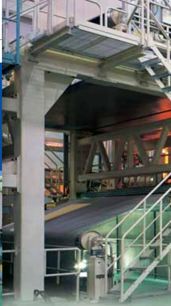
Особенностями данной меловальной установки является модульная компоновка меловальных агрегатов, а также сушильных установок Airturn. Эти новые сушилки обеспечивают бесконтактное переворачивание картонного полотна в процессе одновременной сушки.
