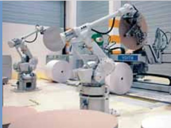
лонов диаметром до 3,5 м. При помощи системы автоматической транспортировки рулоны машинной намотки направляются на два продольно-резательных станка типа VariTop. После этого разрезанные рулоны транспортируются на устройство для автоматического взвешивания, на маркировочную установку и, наконец, на систему упаковки рулонов Twister 2 Line. Затем готовые рулоны передаются цепным транспортером из зала бумагоделательной машины на склад готовой продукции по соединительной галерее.
