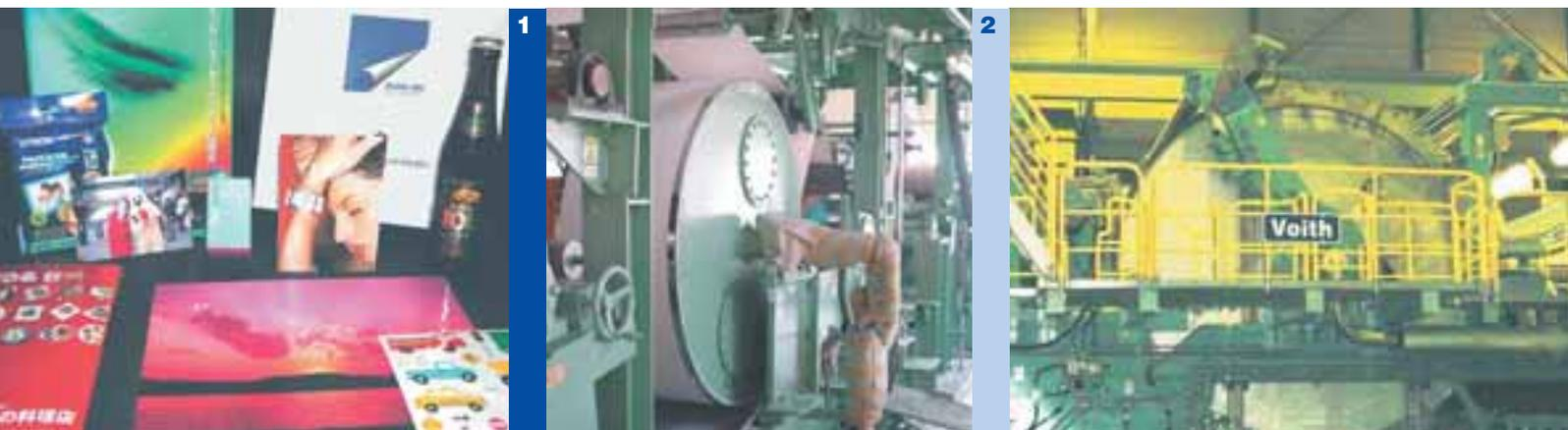
**Так называемое «литое мелование» применяется в производстве картона и графических сортов бумаги, которые требуют особенно высокой белизны, лоска, износостойкости и яркости нанесенной печатной краски.**
