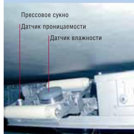
**Рис. 3:** Изменение состояния сукна в течение нескольких недель – проницаемость прессового сукна
