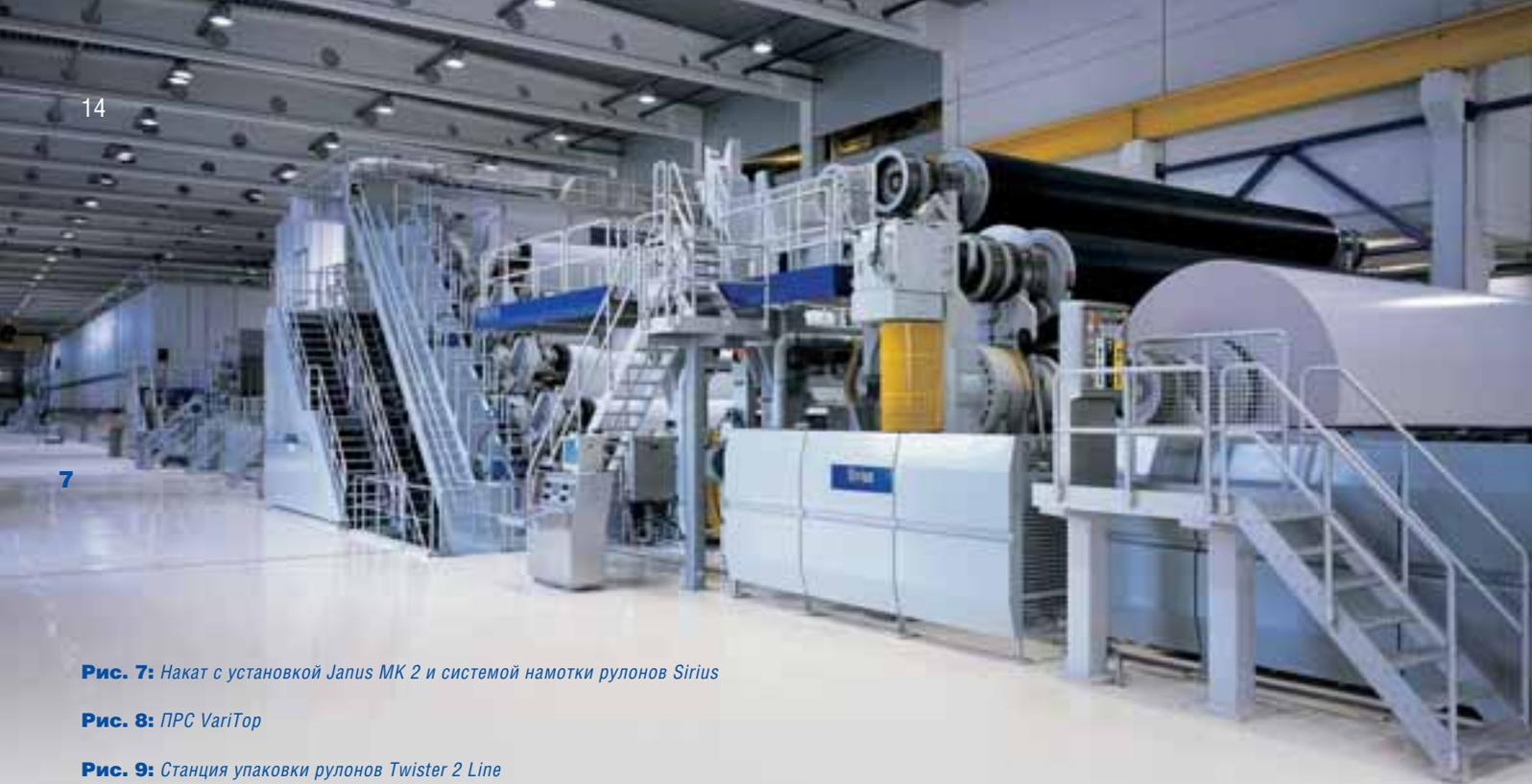
**Рис. 7:** Накат с установкой Janus MK 2 и системой намотки рулонов Sirius
