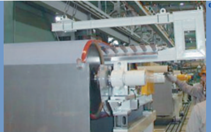
Kuva 6: Compact Washerin helppohuoltainen perälaatikko.
