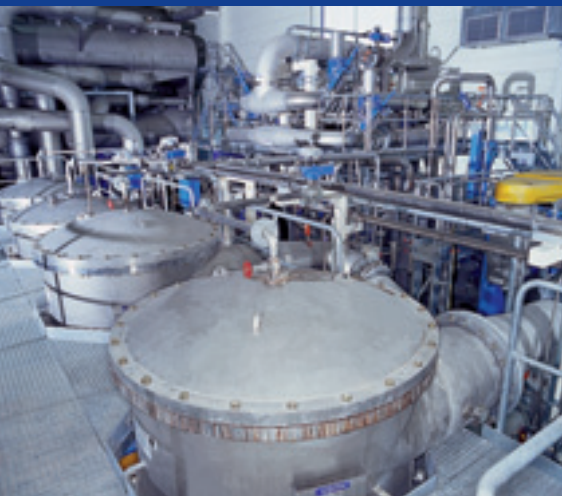
MultiSorter karkeaan lajitteluun ja MultiScreen hienolajitteluun. Molemmissa on C-bar sihtikorit ja MultiFoil-roottorit.
