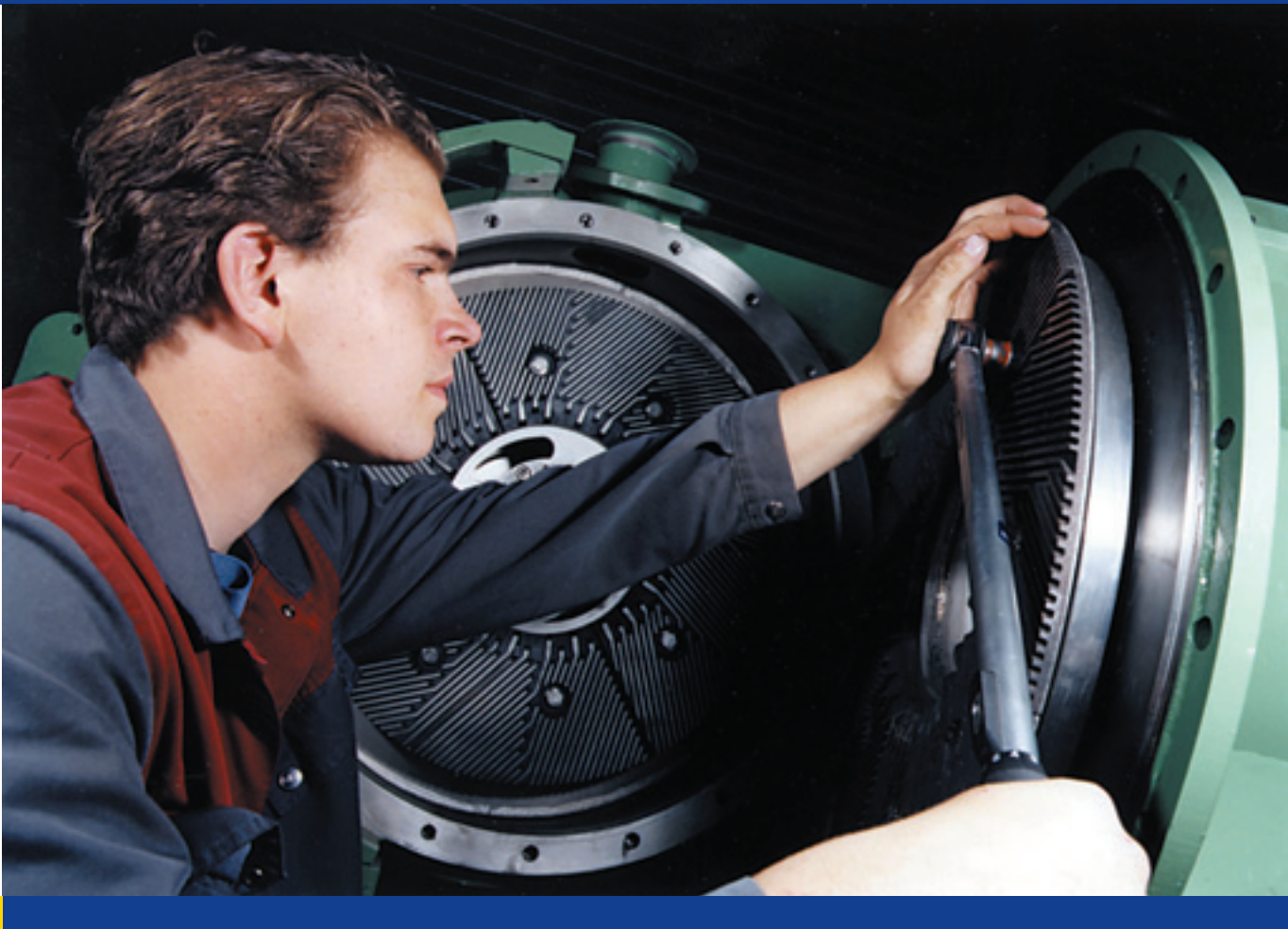
Jauhimen teräsegmenttien vaihto TwinFlo TF1D -kaksoislevyjauhimessa.
