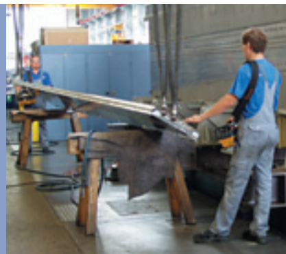
Syöttölevyn asennus perälaatikkoon.
