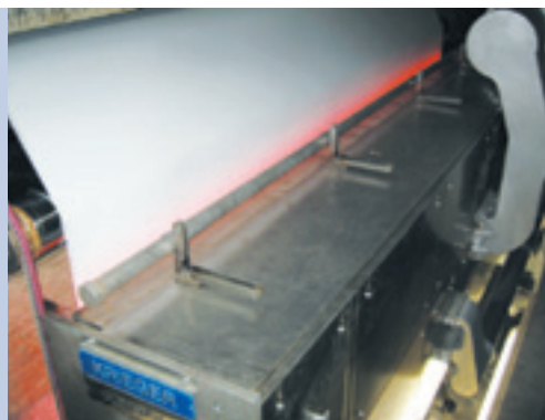
InfraAir-kuivain asennuksen jälkeen.
