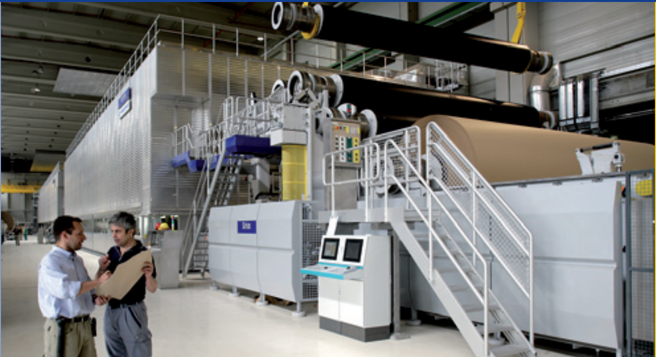
RollMaster ohjaa optimaalista rullausta Sirius-rullaimella.
