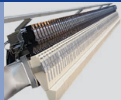
ModuleJet-venttiilit, joiden LC-putkis-toissa on Profilmatic-toimilaitteet.
