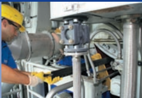
福伊特辊子部服务技术人员 正在更换刮刀片
