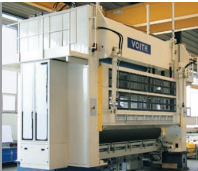
一台 VariFlex 复卷机正在预组装
