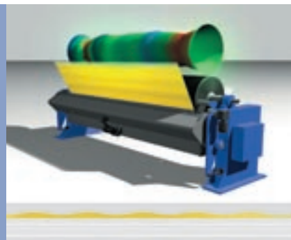
一根常规研磨过的辊子所形成的不一致的涂层厚度
