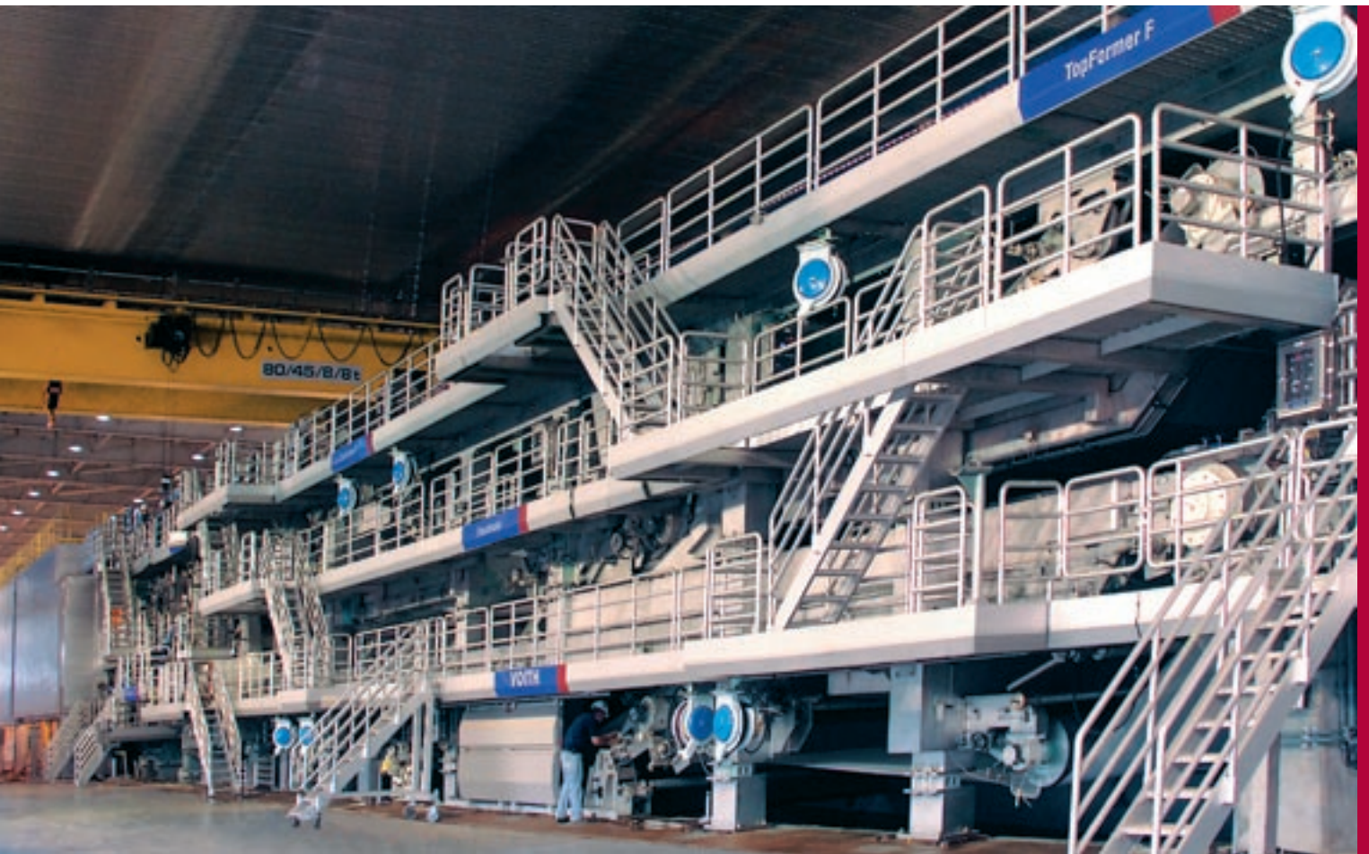
安装在 Monte Alegre 纸厂的 Voith 新纸板机长度近 240 米
