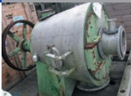
- 壳体的内表面和 外表面严重磨损 - 转子旋翼和筛板损坏
