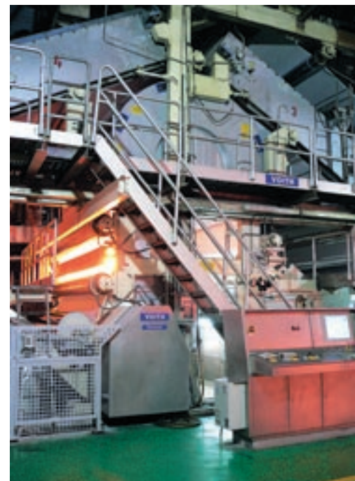
DynaCoat C、IR-dryer 和 HCB-Turn 可以安装在非常有限的空间内。
