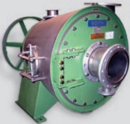
F2型成纤器的卸料机 - 外壳经过整修 - 转子和轴承2经过整修 - 筛板被更换 (按照客户的技术要求)
