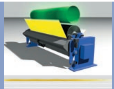
一根3DG研磨过的辊子所形成的均匀的涂层厚度
