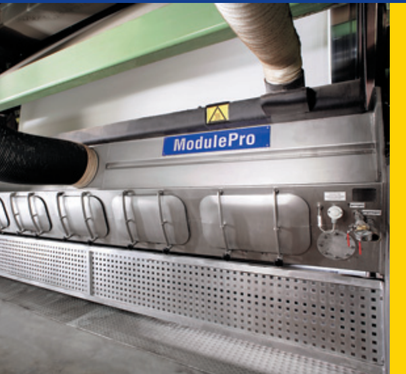
ModulePro C nozzle moisturizer
