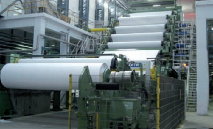
10-вальный каландр Janus MK2 обеспечивает оптимальную обработку поверхности.
