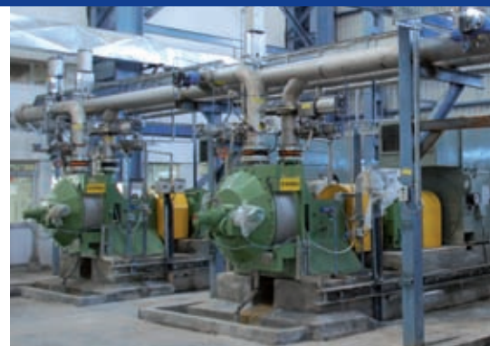
Размольно-подготовительное отделение состоит из двух линий массоподготовки для короткого и длинного волокна.
