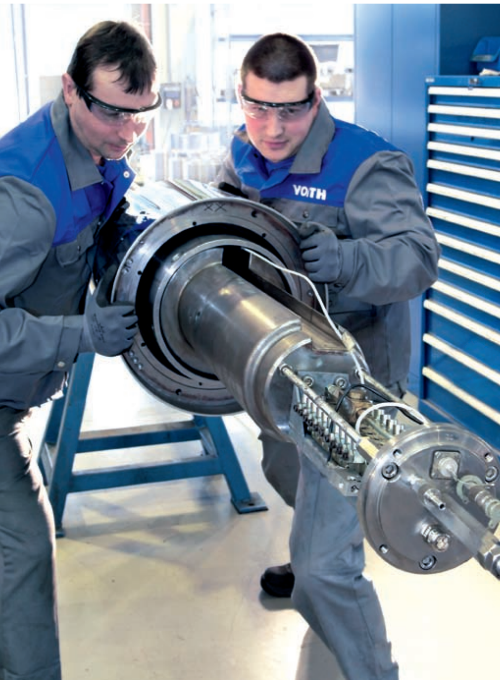
Демонтаж разгонного вала.
