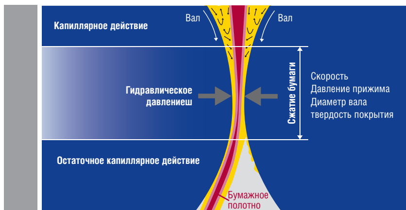
На качество проклейки влияет множество факторов, например, скорость и диаметр вала.
