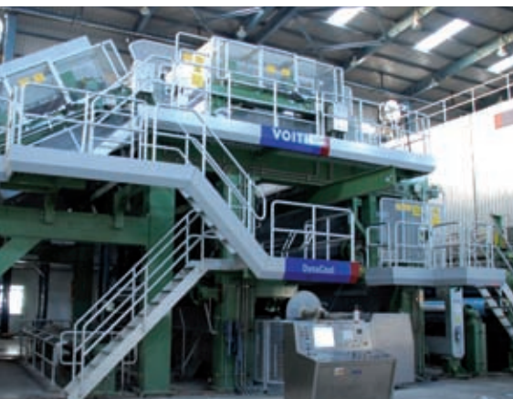
DynaCoat AT с устройством JetFlow обеспечивает оптимальное нанесение меловальной пасты.
