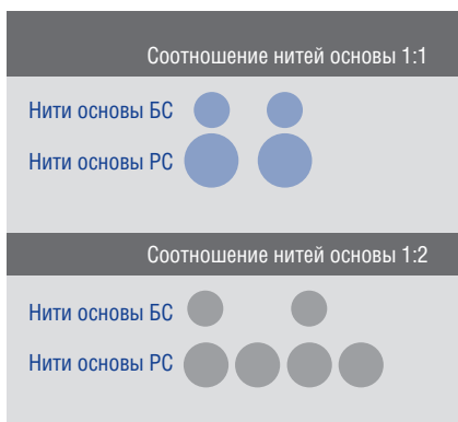
Рис.1: сравнение сеток SSB с соотношением нитей основы 1:1 и 1:2.
