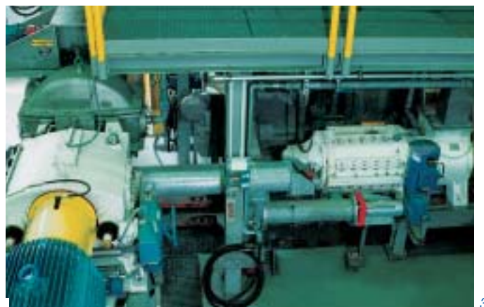
Abb. 3: Disperger und Knet-Disperger im System- Technikum.
