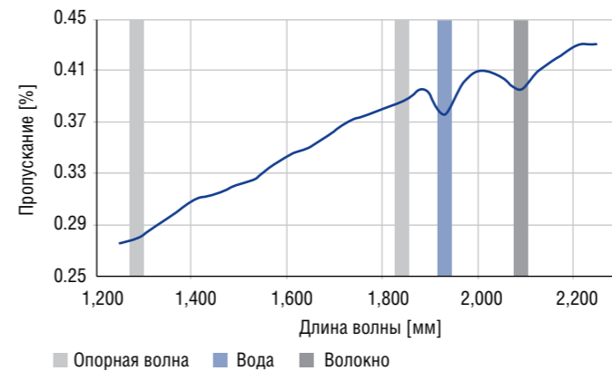
Рис. 2: Инфракрасный спектр пропускания длин волн, используемых в датчике TecoSens.
