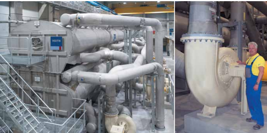
Рис. 1: Новая флотационная установка LowEnergyFlotation (LEF) на фабрике «Перлен Папир АГ».
