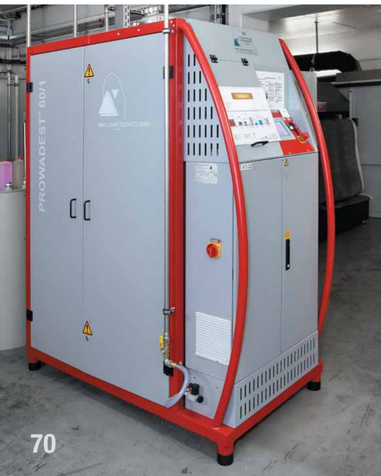
Рис. 1: Вакуумная дистилляционная установка в Хайденхайме, Германия, позволяет сократить количество жидких отходов на 200 т/г.
