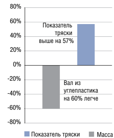
Рис. 3: Преимущества вала из углепластика по сравнению со стальным валом.
