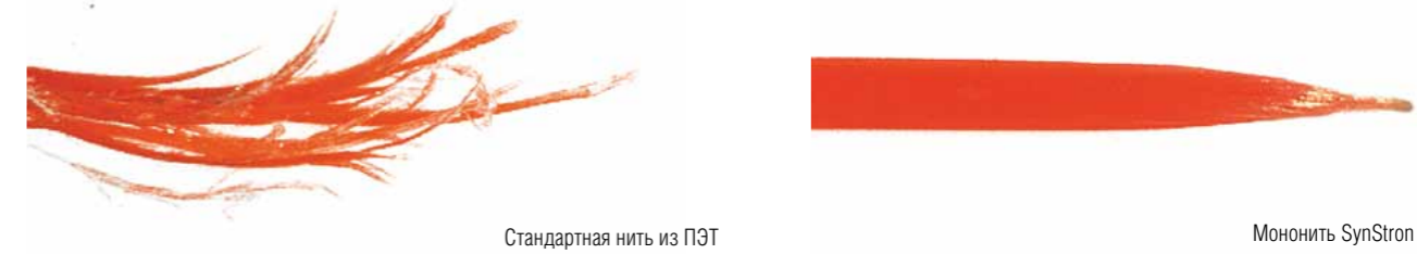
Рис. 4: Нить SynStron менее подвержена расслоению волокон. В то время как стандартная нить из ПЭТ (слева) распадается на множество мелких волокон после внезапного разрыва, нить SynStron сохраняет в месте разрыва четкую форму.
