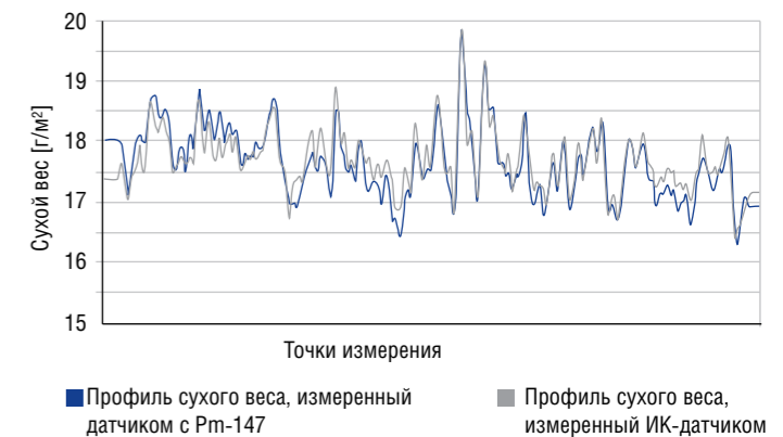
Рис. 3: Сравнение средних значений (тамбура), полученных с помощью традиционного радиометрического метода измерения и датчика TecoSens.
