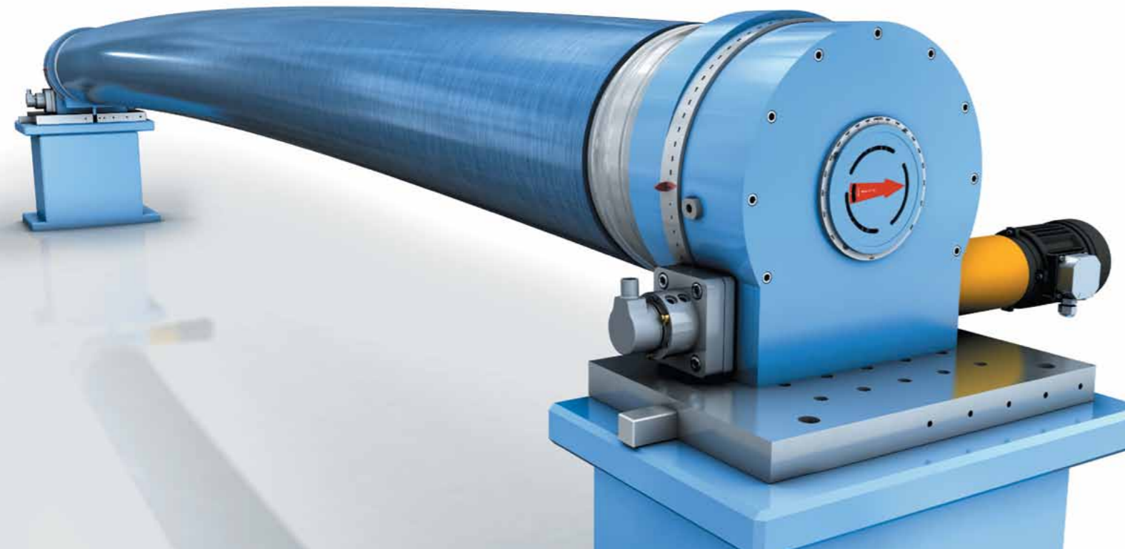
Рис. 1: Непрерывная дуга обеспечивает оптимальный эффект расправления полотна.
