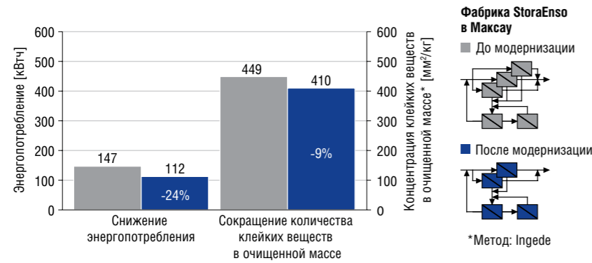
Рис. 3: Снижение концентрации клейких веществ и энергопотребления после установки сит C-bar R на первой ступени и сита C-bar Q на конечной ступени системы сортирования на фабрике StoraEnso в Максая. Это позволило отключить одну из трех сортировок первой ступени.
