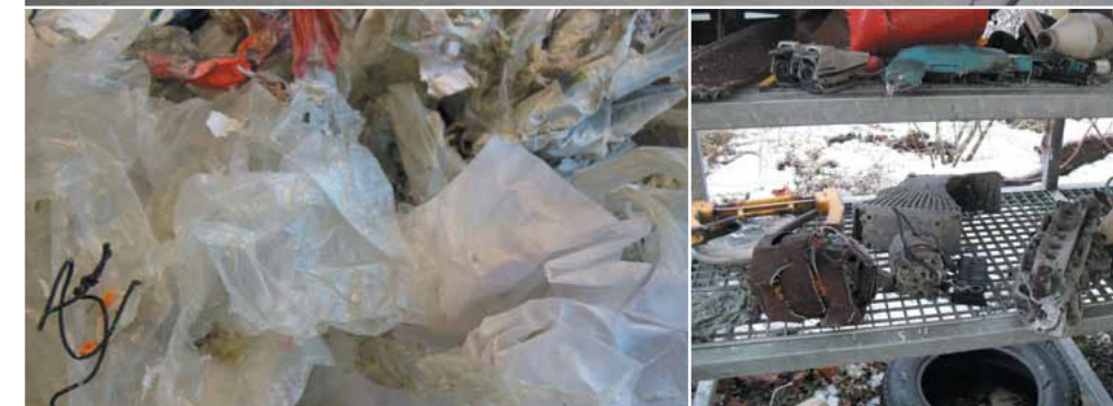
Рис. 6: Типичные загрязнения, отделяемые установкой IntensaMaXX, а затем удаляемые из сортировочного барабана.
