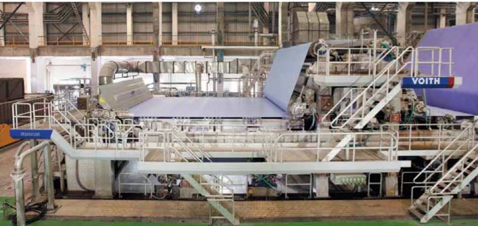
Рис. 2: DuoFormer D и DuoShake гарантируют высокое качество бумаги в формующей части.
