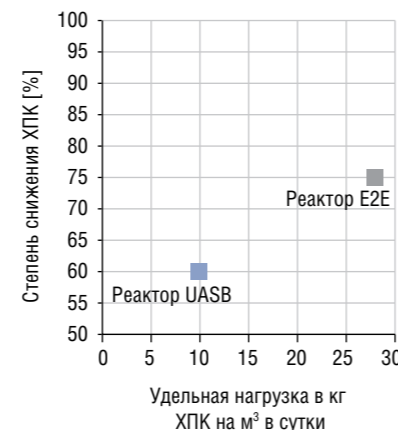
Рис. 2: Сравнение реактора UASB с реактором E2E компании «Фойт».
