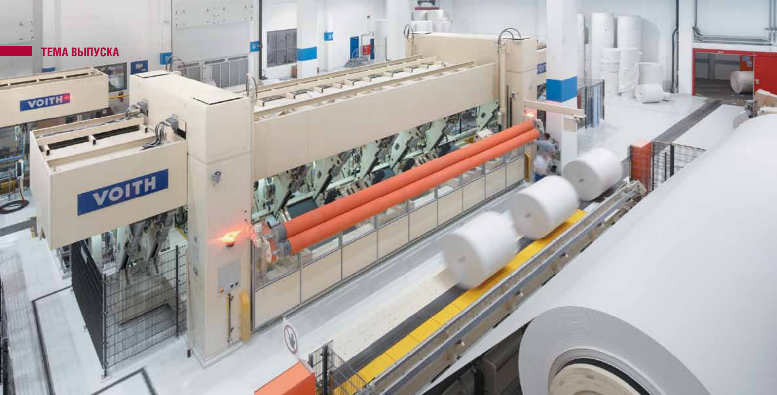
Рис. 4: Принцип центрального привода, примененный на обоих ПРС VariTop обеспечивает хорошую начальную плотность намотки - это важно для переработки на высокоскоростных печатных станках.
