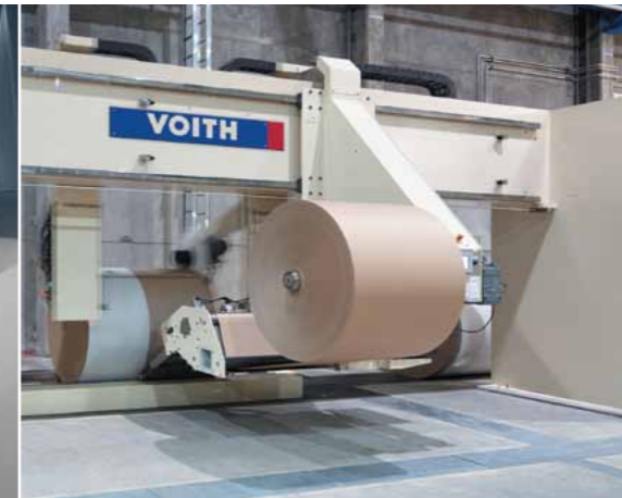
Рис. 2: Передвижная упаковочная головка станка ClassicPlus.
