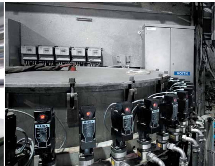
Рис. 2: Актуаторы OnQ ModuleTap управляют существующим напорным ящиком с регулированием расхода разбавительной воды.
