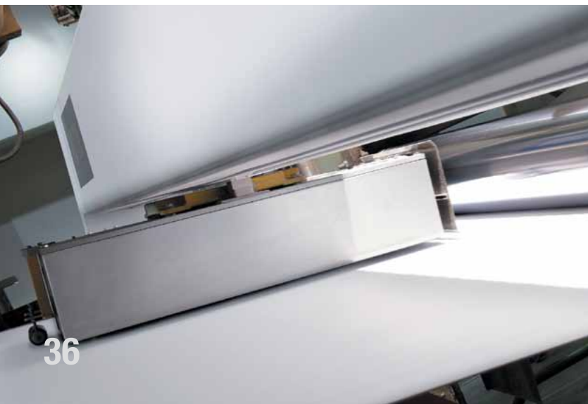
Рис. 1: Установка сканера «Voith LSC» позволила снизить затраты на обслуживание.
