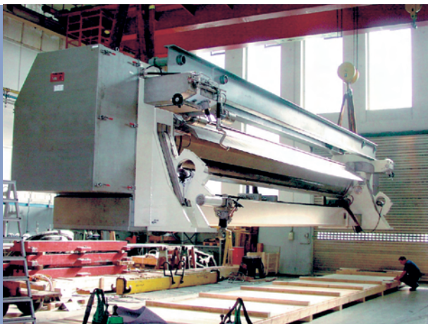
Ein DynaCoat für eine 10 m breite Feinpapiermaschine vor dem Versand am Stück
