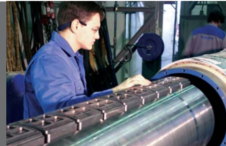
Die Achse einer Nipcorect™-Walze wird präzise in den Walzenmantel eingeführt.
