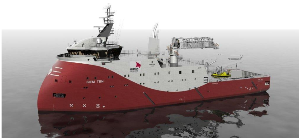
Die Siem Moxie: Das erste Arbeitsschiff im X-Bow Design mit Voith Antriebstechnik
