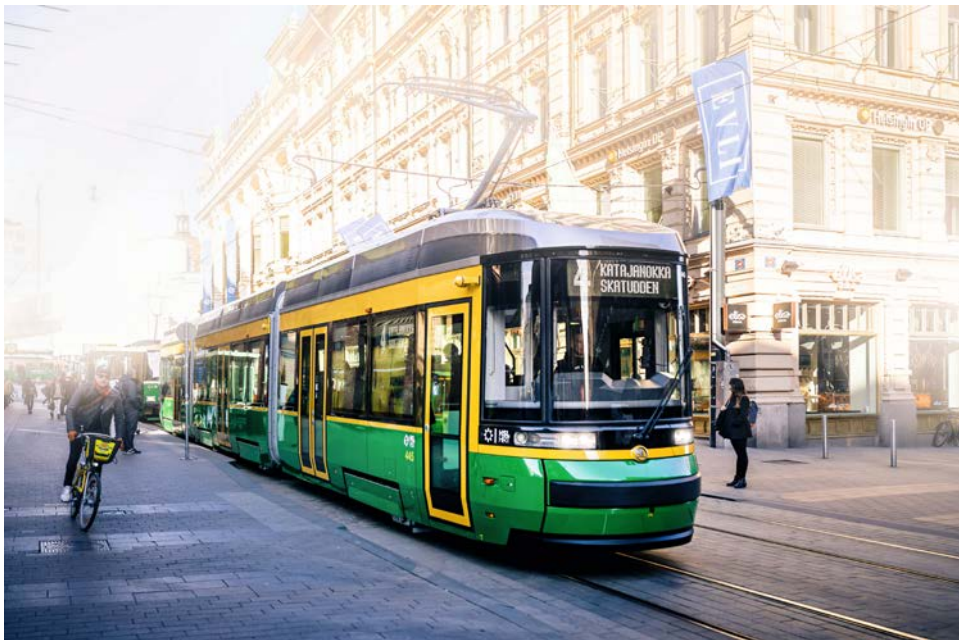
Bild: Bis Mitte 2019 fahren insgesamt 70 Niederflur-Straßenbahnen mit elektrischem Antriebssystem von Voith durch die Straßen von Helsinki.
