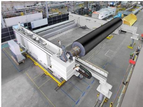
Der vollautomatische Prozess des TwinDrive eliminiert Totzeiten beim Volltambourwechsel und steigert so deutlich Durchsatz und Produktivität.
