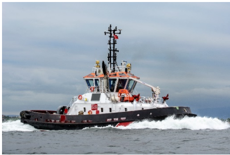
Schlepper der VectRA-Serie sind Hochleistungs-VSP-Traktorschlepper (Voith Wassertrecker), die für maximale Effizienz ausgelegt sind.
