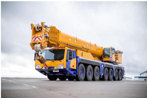
Der AC 450-7 ist mit einem Mercedes-Benz-Antriebsstrang mit einer verschleißfreien Turbo-Retarder-Kupplung von Voith ausgestattet.
