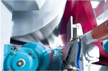
Durch die für höhere Flächengewichte optimierte Anordnung von Blasdüsen und Luftleitblechen ermöglicht der Voith TailStabilizer nun auch bei Kartonmaschinen mit zweireihiger Trockenpartie das seillose Überführen des Streifens.
